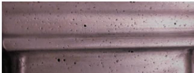
*Picaduras en la superficie externa de la pieza, esto fue causado por una reacción entre el metal fundido y el recubrimiento del molde.*
