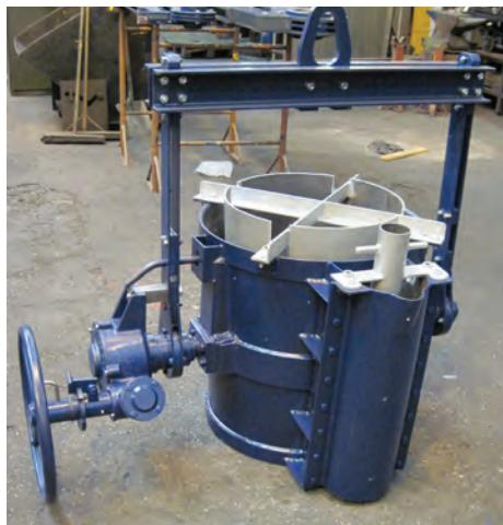
Como la forma de tetera provee un buen anclaje para el refractario moldeable, su remoción probablemente va a requerir mucha mano de obra, utilización de martillos neumáticos, etc., lo que conlleva temas de seguridad.
