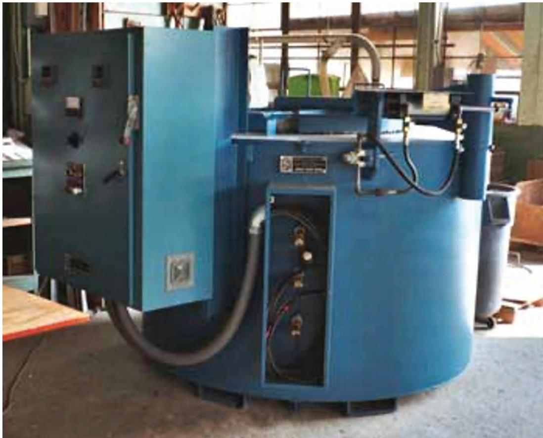
Si se vacía el crisol y se le desconecta el suministro de entrada, utilizará 6.000.000 BTU solo para volver a llenarse. La velocidad de fusión baja mucho con el crisol vacío con respecto al crisol lleno de metal. Podría llevar seis horas para recalentar y fundir el metal hasta volver a tener la cuba llena. Para la primera mitad del tazón, iusará 2.000 BTU por libra de funda!
