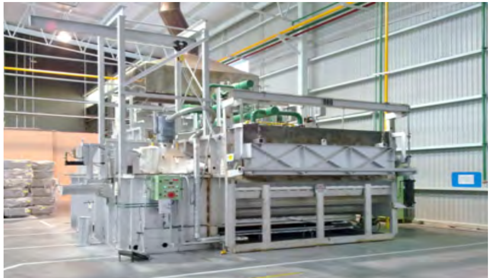
Horno de Fusión de Bajo Techo
