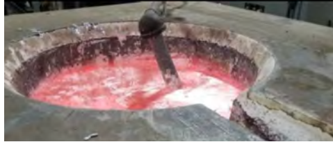
El mismo horno luego de la limpieza producirá menos piezas scrap.
