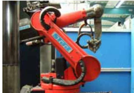
Robot Reis tipo RV en una celda de colado automático. Robusto, diseño específico para fundiciones, con mecánica que economiza espacio, confiable y probado en campo.
