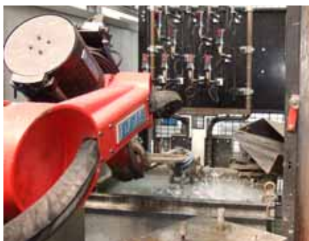
Enfriado y verificación de la pieza en la celda economizadora de espacio, con recorridos cortos, rápida y confiable.
